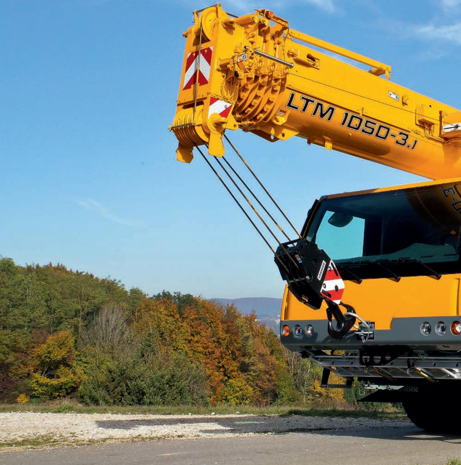
Ein langer Teleskopausleger, hohe Tragkräfte, eine außergewöhnliche Mobilität sowie eine umfassende Komfort- und Sicherheitsausstattung kennzeichnen den Mobilkran LTM 1050-3.1 von Liebherr. Der 50-Tonner bietet Spitzentechnologie für mehr Nutzen im praktischen Einsatz.
